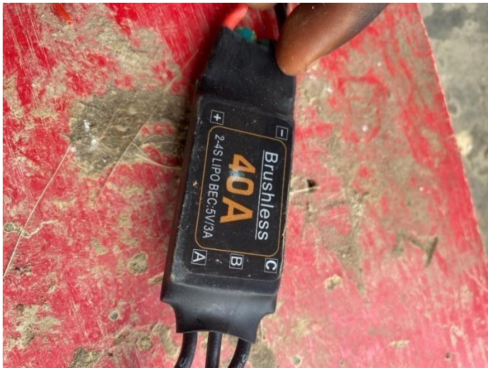
Fig 3.5: A 40A ESC
