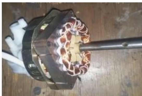
FIG 3.4: Disassembled Fan Motor
