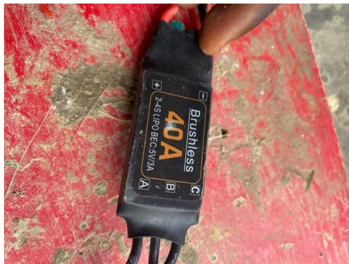
Fig 3.5: A 40A ESC
