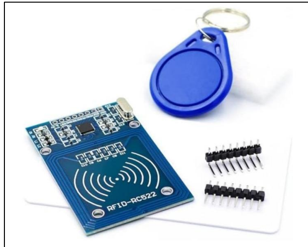
Fig. 3.5 RFID Reader & Tags
